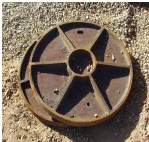
شکل 1-8- دریچه‌ی چدنی با چدن خاکستری (انبار یزد)
