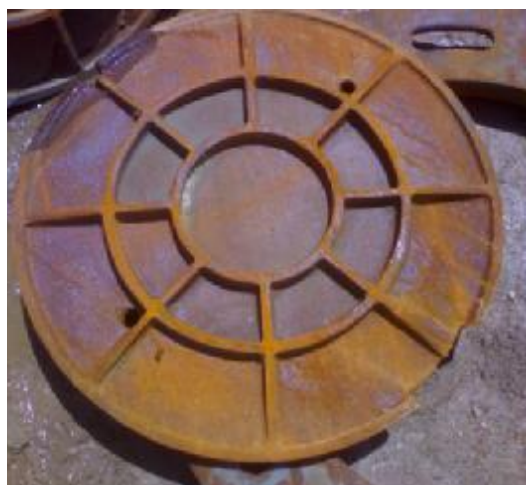
شکل 1-12 - دریچه‌ی از جنس چدن خاکستری (انبار شیراز)
