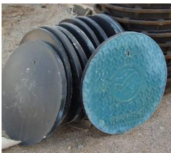
شکل 1-11- دریچه‌ی پلیمری (انبار یزد)
