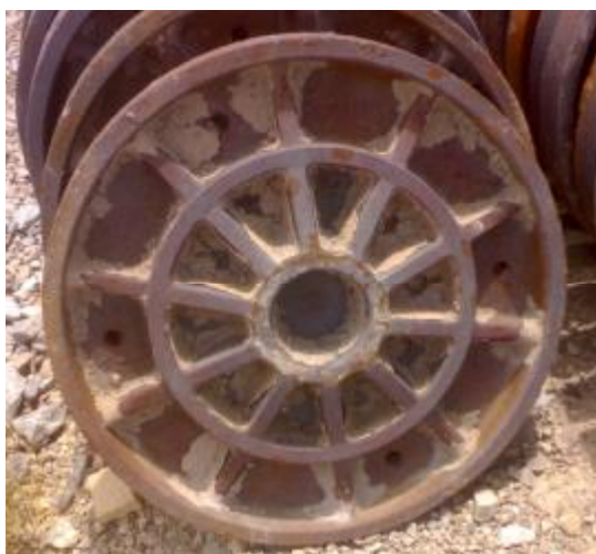
شکل 1-15 - دریچه‌ی از جنس چدن خاکستری مطابق با استاندارد C۲۵۰ - نمای زیر (انبار اصفهان)
