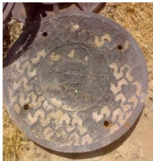
شکل 1-16- دريچه‌ی از جنس چدن خاکستری مطابق با استاندارد D۴۰۰-نمای بالا (انبار اصفهان)
